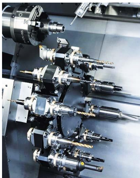
Сурет 3. 24 стационарлық және жетек құралын бекітуге арналған револьвер [8]
